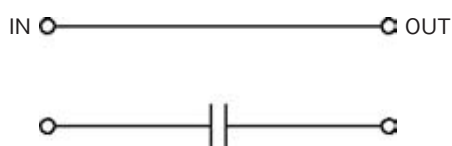
図 24 同軸外導体容量結合型ロータリジョイントの等価回路
