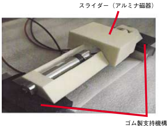
図14 音波浮揚利用リニアガイド (試作例2)
