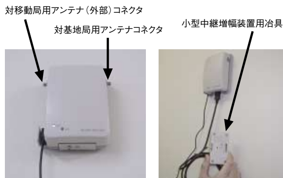
小型中継増幅装置 外観
