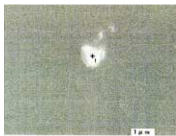
図1-2 ガラス表面に付着した異物のSEM写真
