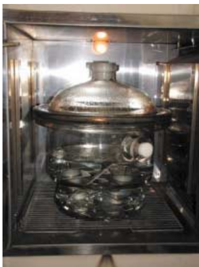
図7 耐水・耐薬液試験状況
