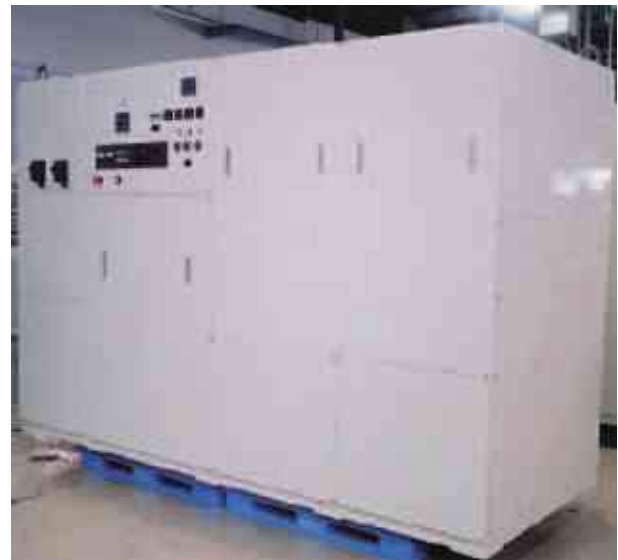
12 パルス方式高調波抑制型 IH 電源（800kW）
