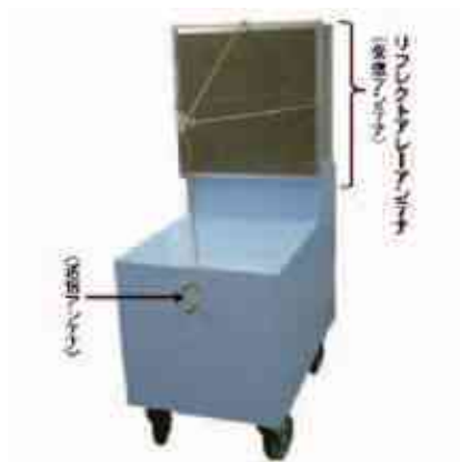
図3.2-4 電波テレビカメラ装置とミリ波帯大型リフレクトアレーアンテナ
