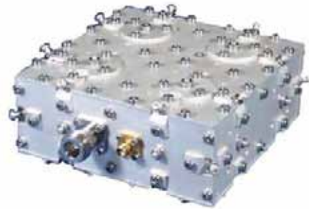
図 30 2GHz 帯トリプルモード誘電体共用器
