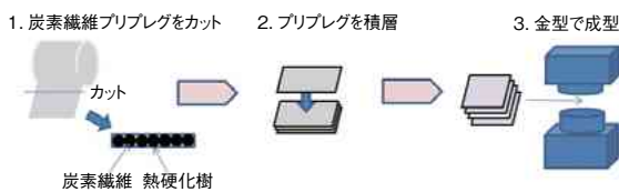
図 3 CFRP のプレス成型法
