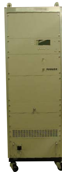
図6 C 帯 1.6kW 出力 SSPA 外観
