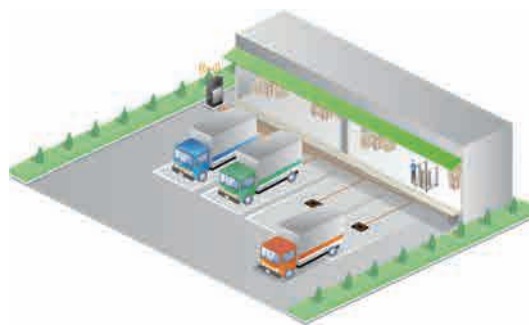
図4-4 EVワイヤレス給電用インバータの実用例
