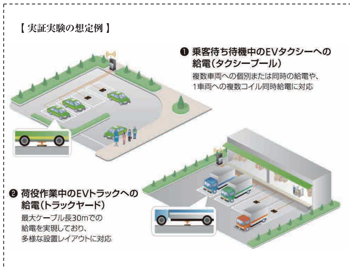
図1 EV用ワイヤレス給電システム 実証実験の想定例
