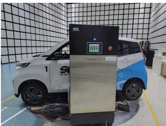
図4 EMC試験サイトでの試験模様
