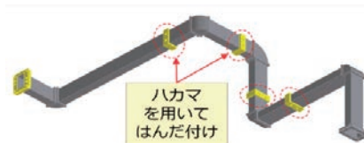
図2 ハカマ構造導波管
