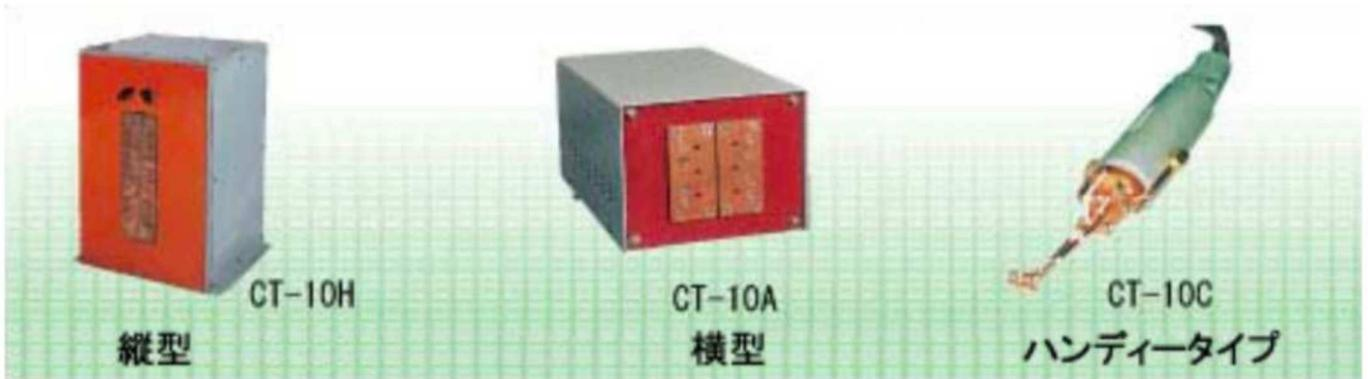
高周波変流器とは、インバーター出力と加熱コイルとの間に接続される整合用トランスで、加熱コイルのインピーダンスが低い場合（コイルの巻き数が少ない場合）に使用します。
