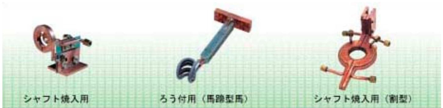
高周波誘導加熱装置は、加熱コイルで磁界を作り、対象物を自己発熱させます。加熱コイルの形状や配置により、加熱の状態が大きく変わります。
