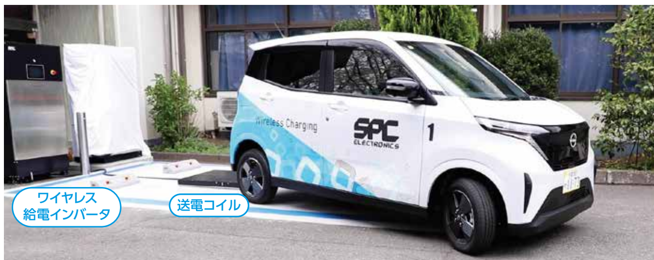
ワイヤレス給電の実験エリアとEV
